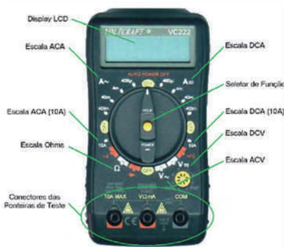
Fig. 25: Foto de um multímetro *VOLTCRAFT* com auto range
